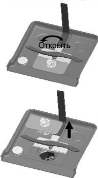
Шаг 1: Поверните фильтр против часовой стрелки.
