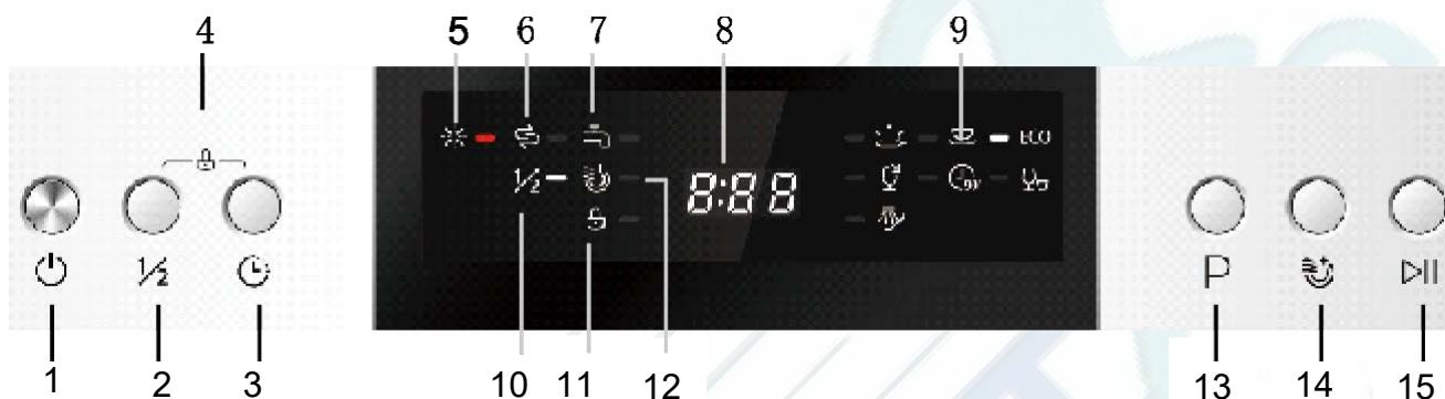
1. Кнопка Вкл/Выкл: включает и выключает прибор;
