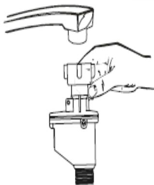
Прибор следует подключать с помощью нового комплекта для подключения к водопроводному крану. Нельзя повторно использовать старые комплекты шлангов для подключения.
