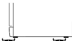
Как только прибор установлен для выравнивания, высота посудомоечной машины может быть изменена путем регулировки уровня завинчивания ножек.
